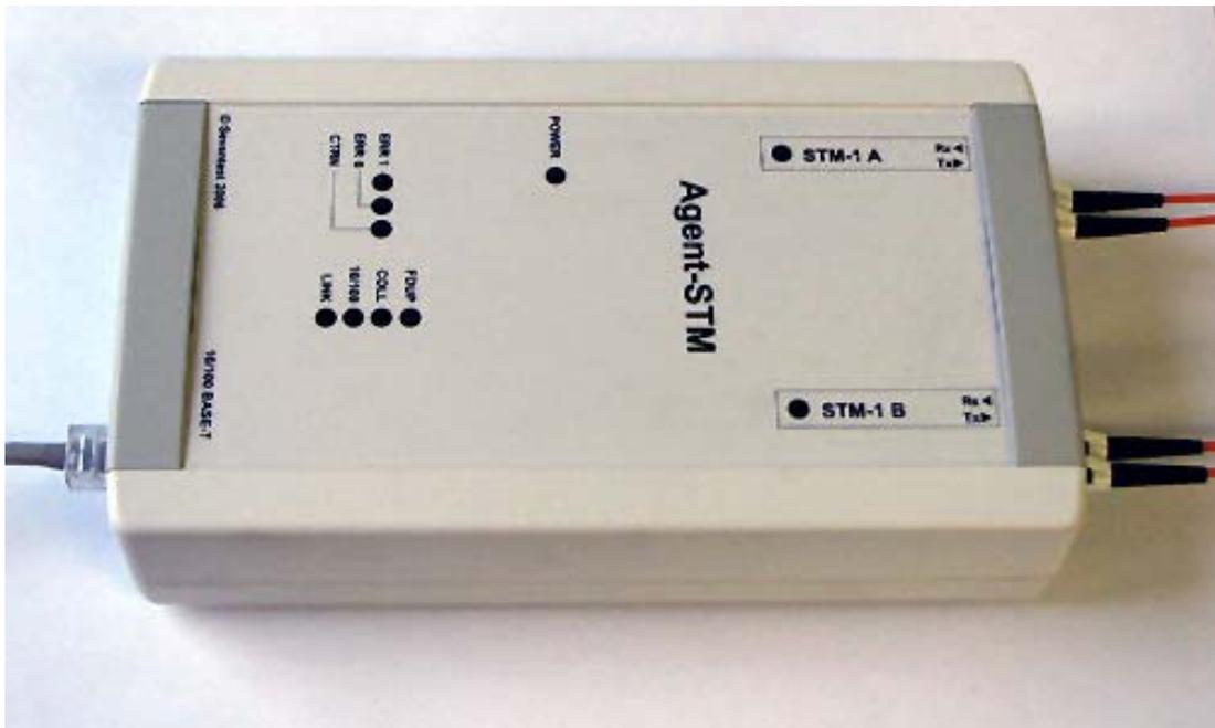
Agent-STM — тестер-обработчик 2-х потоков STM-1 SDH 155 Мбит/с.
